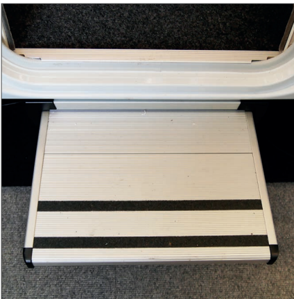
Elektrische Trittstufe mit automatischer Einfahrfunktion
